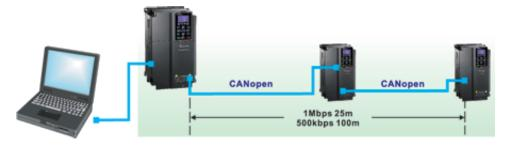
Поддержка связи со всей продукцией Delta для промышленной автоматизации (имеет встроенные файлы EDS всех устройств)
