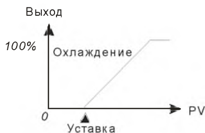
Рис 2: ПИД-регулирование, управление охлаждением
