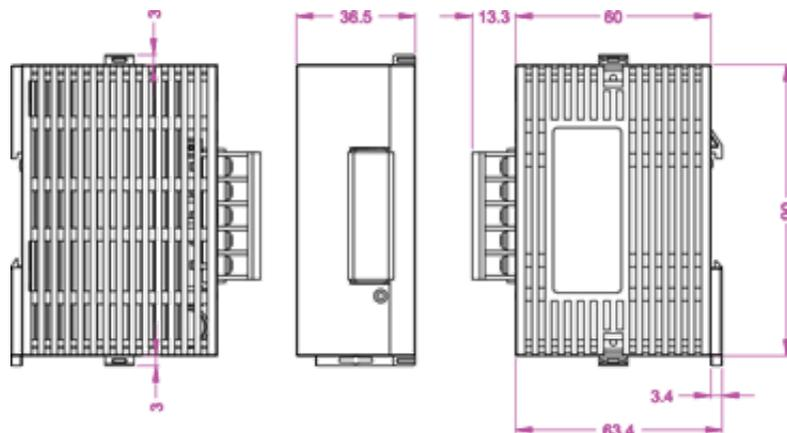
Напряжение: 1-фазовое, вход 85-264 VAC, выход 24 VDC.
