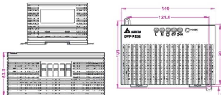
Напряжение: 1-фазовое, вход 85-264 VAC, выход 24 VDC.
