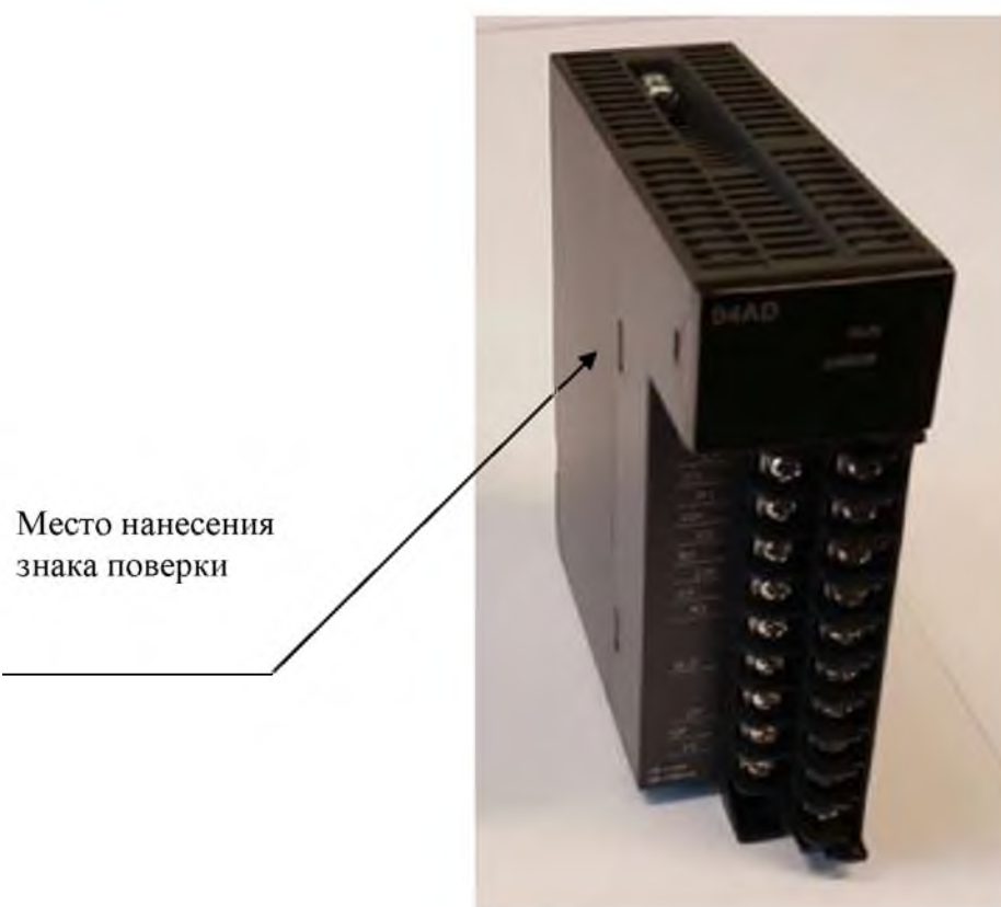
Рисунок 3 - Общий вид модулей ввода/вывода сигналов и место нанесения знака поверки
